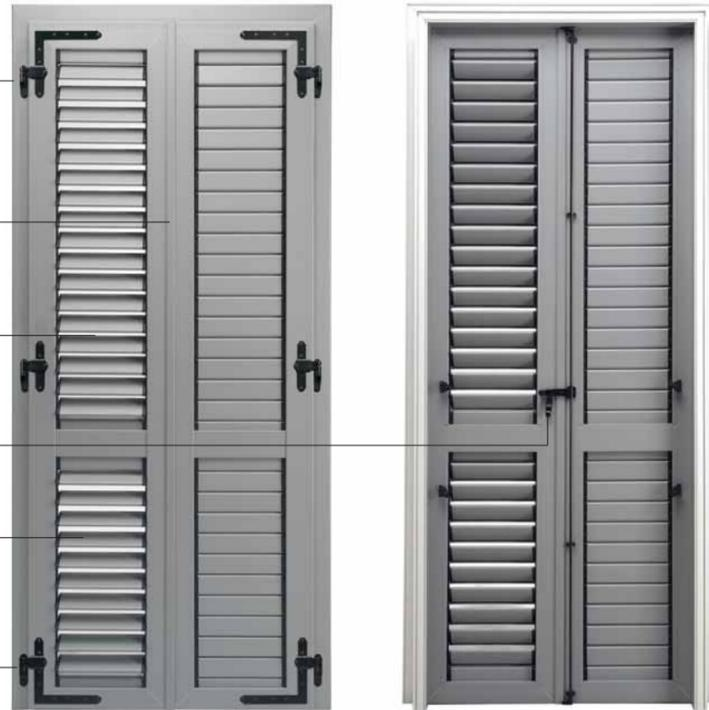
Persiana PVC è un sistema di oscuramento esterno. La ferramenta è regolabile. Gli angoli delle ante, saldati su 4 lati, sono ulteriormente rinforzati da una squadretta metallica in acciaio; inoltre, i rinforzi verticali ed orizzontali sono collegati da un profilo in PVC saldato.
